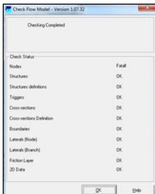
Afbeelding 14: Check flow model met fout indicatie in SOBEK model aangeduid met 'Fatal!'.
